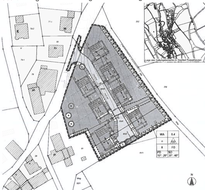
Lageplan zum Bebauungsplan „Rüsselhausen Ost“ mit Satzung über örtliche Bauvorschriften (Fassung vom 12.08.2019), genordet, ohne Maßstab
